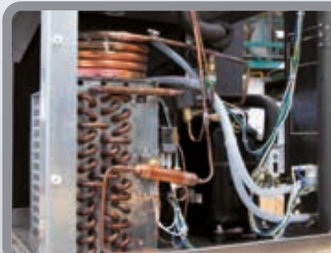
Condensazione mista Mixed cooling.
