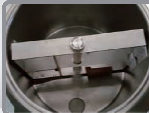
Agitatore pastorizzatore 40/60 Litri. Agitator for 40/60 Liters pasteurizer.
