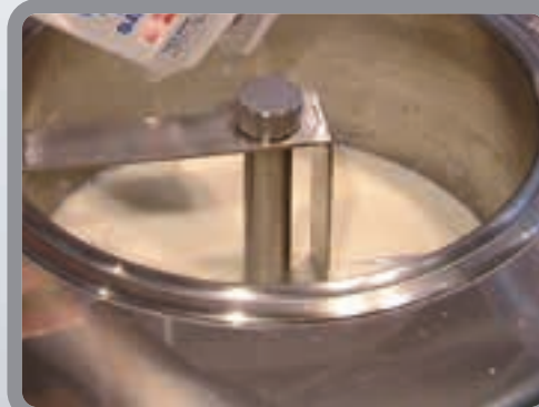
Vasca di produzione verticale permette di controllare la trasformazione della miscela durante tutta la fase di lavoro Vertical tank allows you to check state of mixing throughout the entire production cycle
