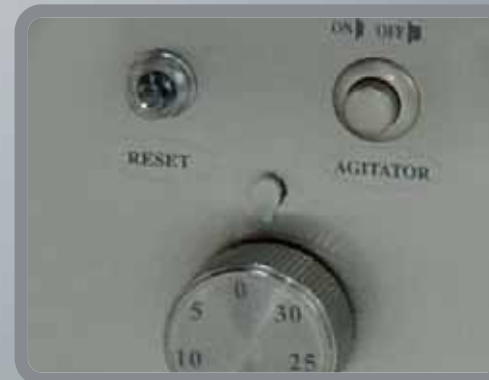
Pannello comandi con timer permette di regolare la durata ideale del ciclo in rapporto al tipo di miscela. Command panel with timer allows the user to set the the real length of the batch freezer in relation to the type of mix.
