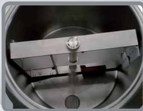
Agitatore pastorizzatore 40/60 Litri. Agitator for 40/60 Liters pasteurizer.
