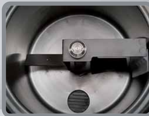
Agitatore pastorizzatore 15 Litri. Agitator for 15 Liters pasteurizer.
