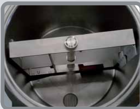
Agitatore pastorizzatore 40/60 Litri. Agitator for 40/60 Liters pasteurizer.
